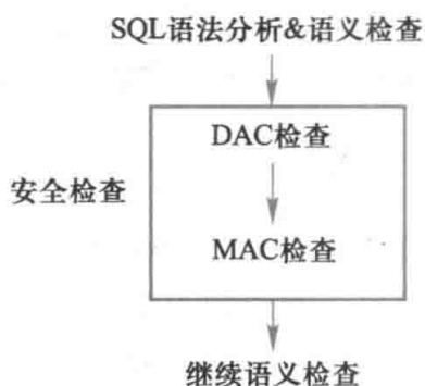
图 4.5 DAC+MAC 安全检查示意图
