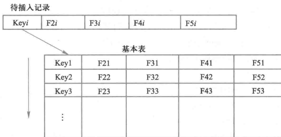
图 5.1 用全表扫描方法检查主码唯一性
